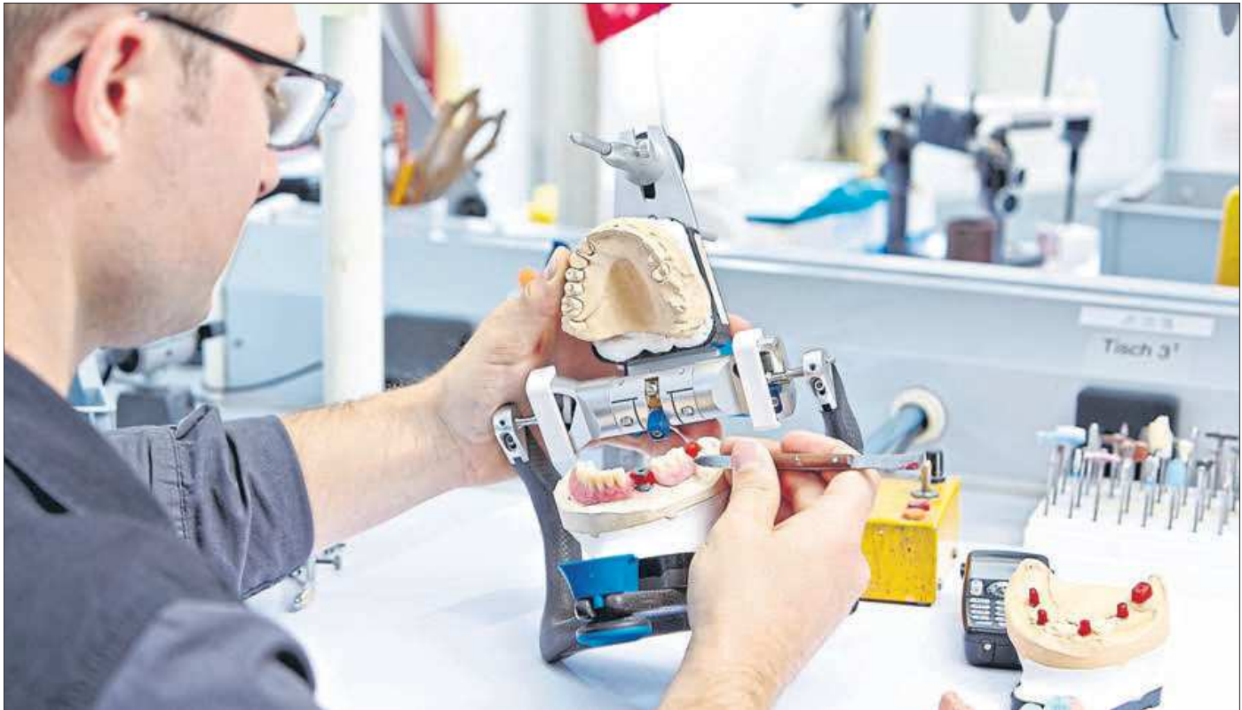
Ein Zahntechniker bearbeitet die Aufstellung für eine Ästhetikanprobe. Dabei wird ein Gipsmodell in einen Artex-Artikulator gespannt, welcher die Kieferbewegung eines Patienten simuliert. Foto: Kimmel Zahntechnik
