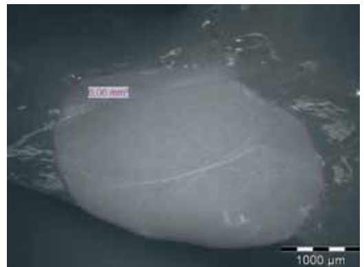
Abb. 8: Eine Bruchgefahr besteht für Zirkonoxidbrücken bei Unterschreiten der vom Hersteller empfohlenen Verbinder-Mindeststärke (9 mm²). Hier waren es zum Beispiel nur 6,06 mm².
