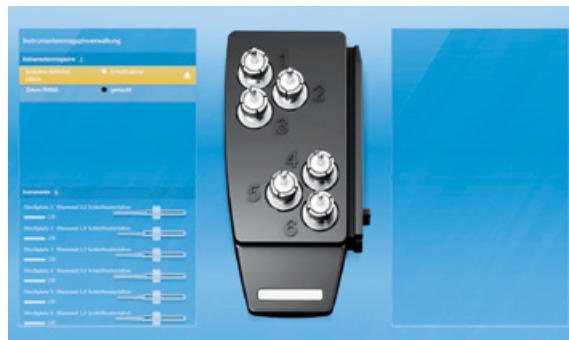
Abb. 17: Konfiguration des Werkzeugwechsels im CAM-Modul.
