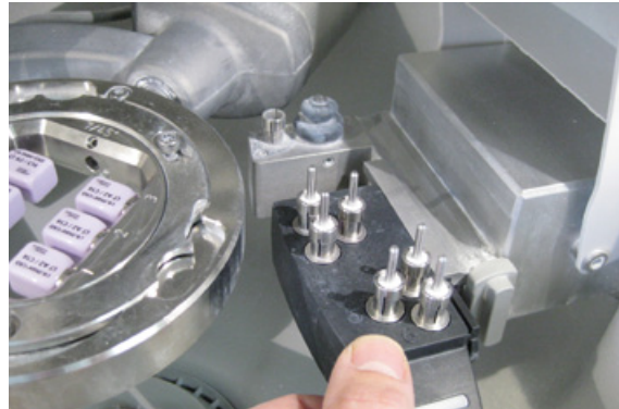
Abb. 16: Wechsel des Werkzeugmagazins.
