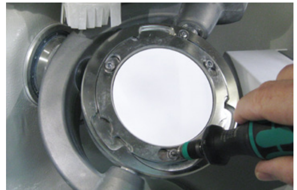
Abb. 12: Einspannen der Zirkoniumdioxid-Disc.
